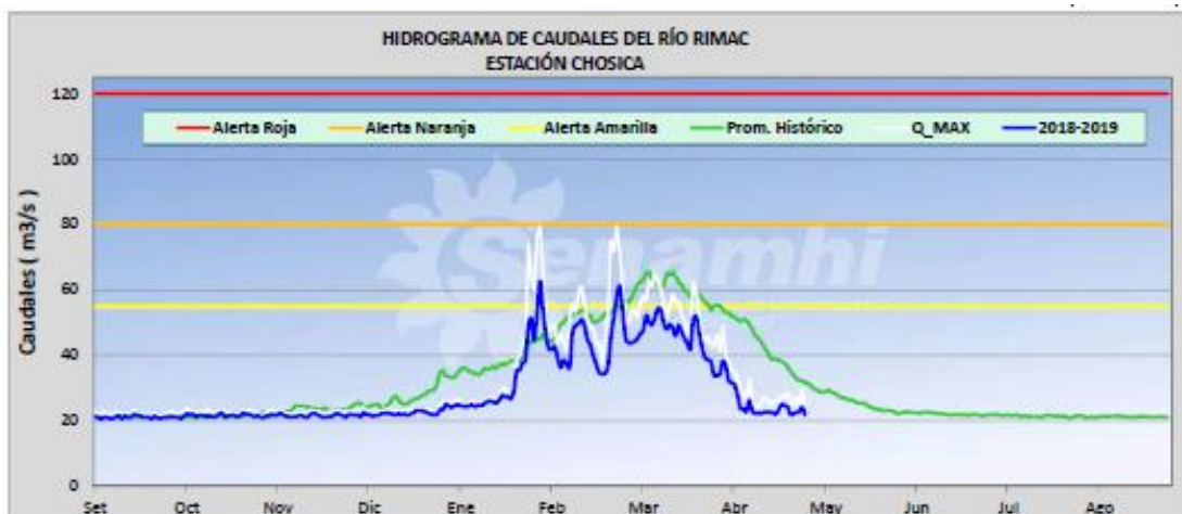
Ilustración 5: Datos De Caudal Del Río Rímac.
