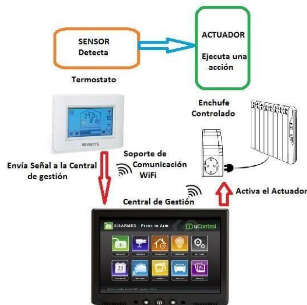
Figura 60: Esquema de elementos de instalación domótica. (2015)
