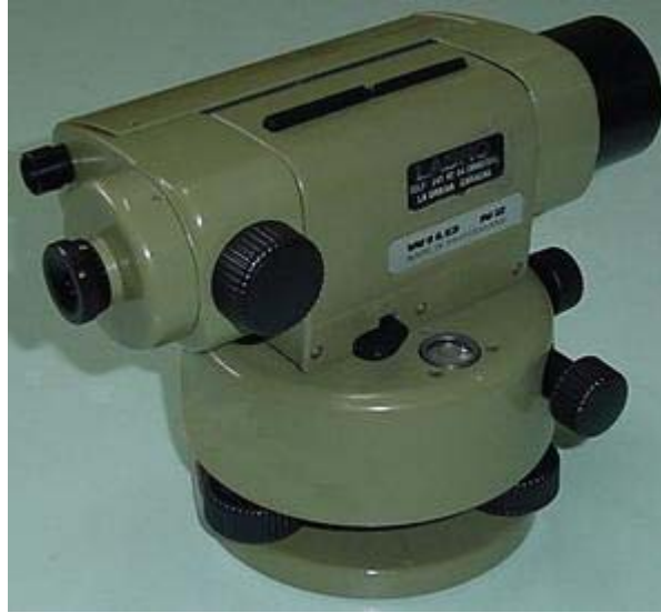
Figura 2.28. Nivel Wild N2 con nivel tórico de doble curvatura
