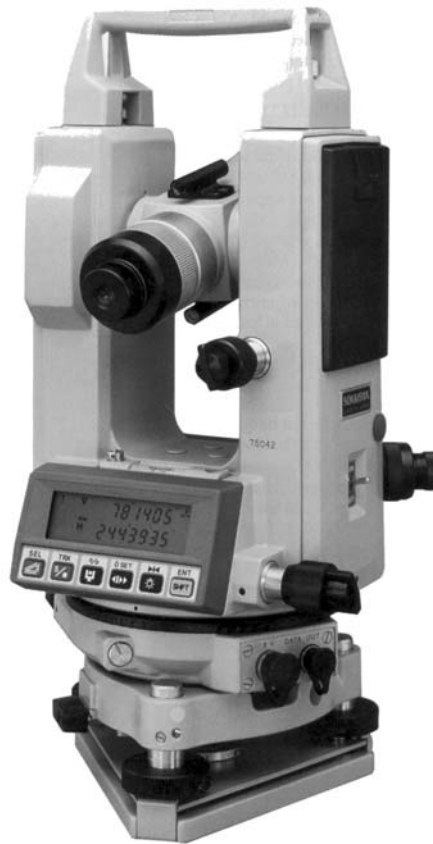
Figura 2.24. Teodolito electrónico DT4 de Sokkia
