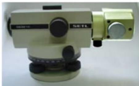
Fig. 95. Nivel de precisión y placa plano paralela
