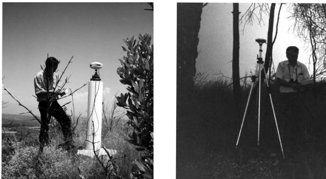
Fig. 28 GPS Estación de referencia y estación receptora
