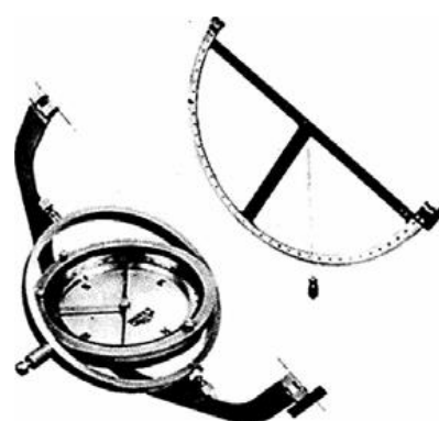
Fig.25 brújula colgante para estaciones alternas
