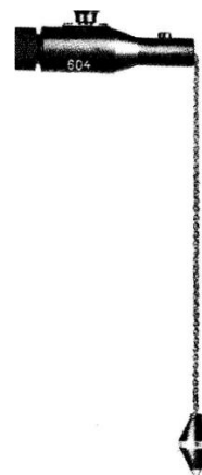
Fig.23 Brazo de soporte ploma, como referencia para el teodolito
