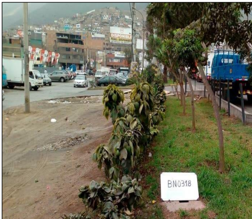
Figura 5: Hito De Nivelación Superficial
