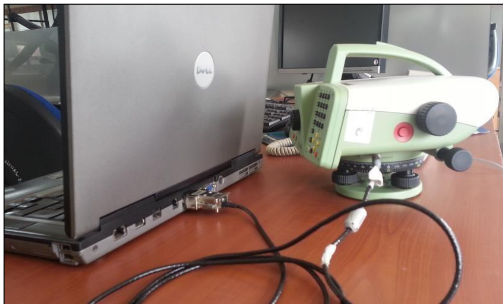
Figura 41: Descarga De Data De Nivelación
