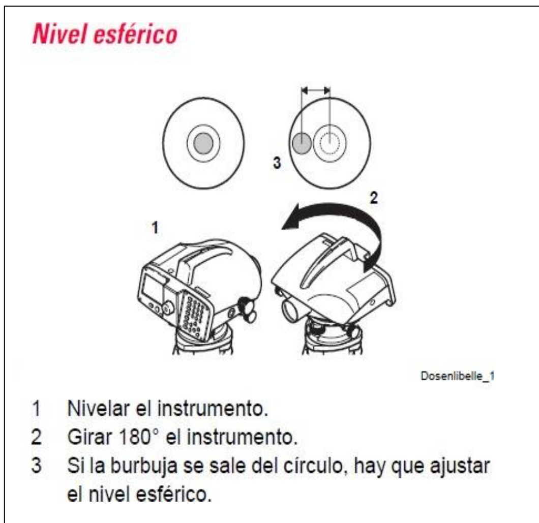
Figura 35: Comprobación De Burbuja De Nivel Esférico
