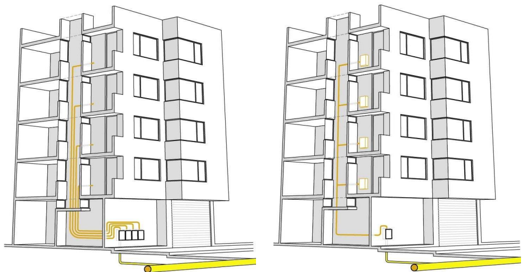
Fig. 13 – Representacion Montante con Banco de medidores y montantes individuales Fuente : Ing Gerardo Medina – Calidda Gas natural del Peru 2010
