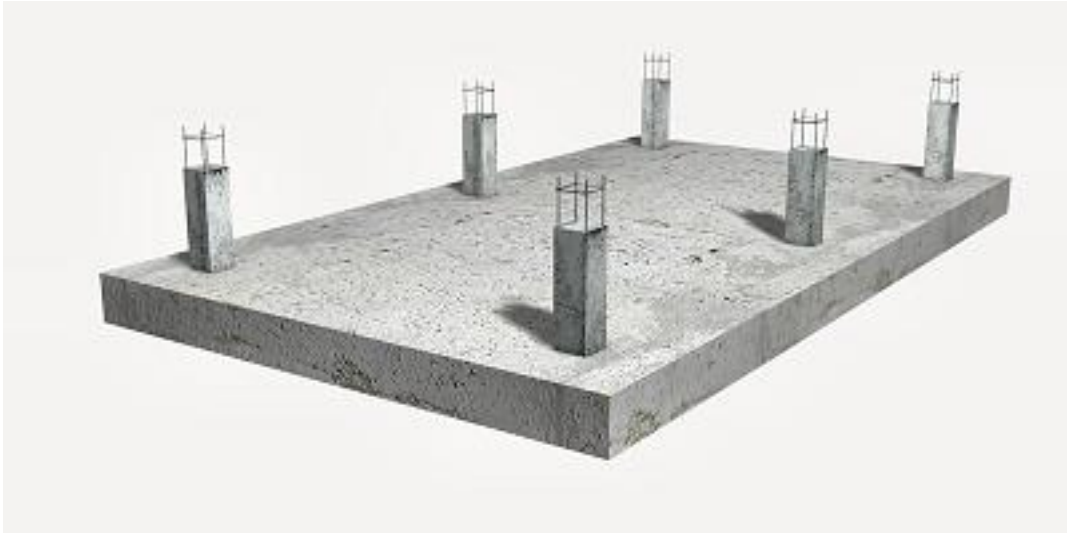
Fig. N° 02, Platea de cimentación, fuente geotecniafacil.com/tipos-cimentaciones-superficiales-o-directas/
