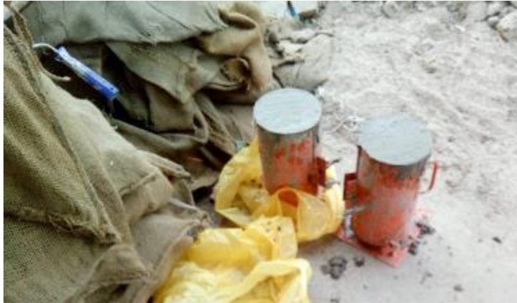
Muestra de concreto realizados en situ.
