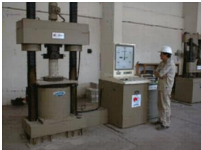
Ensayo de compresión en probeta de concreto
