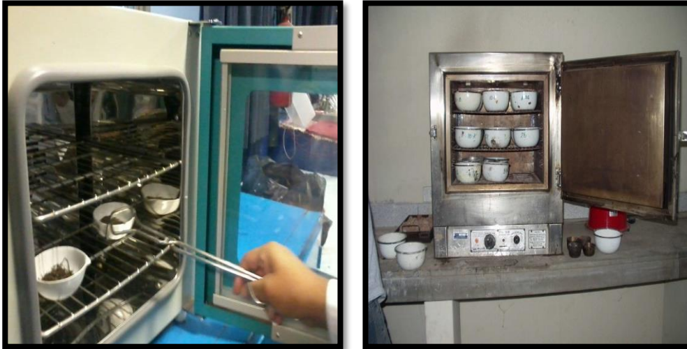
Fig. N° 13 – Secado de muestras de suelos en el horno
