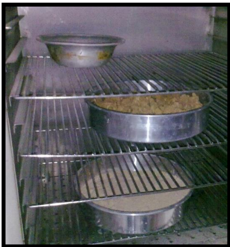
Fig. N° 15 – Secado de la muestra de suelo en el horno
