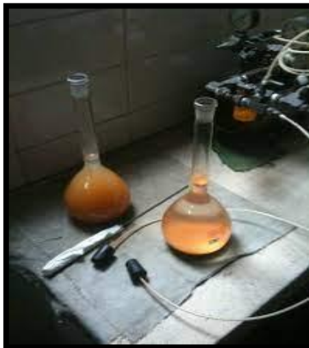
Fig. N° 19 – Aforado hasta el nivel de calibración de la fiola
