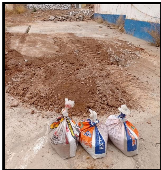
Fig. N° 22, 23 - Realización de calicatas y recolección de muestras de suelo
