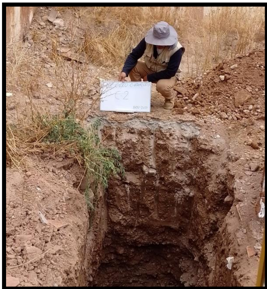
Fig. N° 22, 23 - Realización de calicatas y recolección de muestras de suelo
