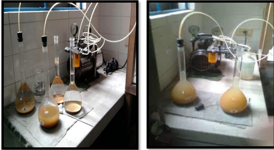
Fig. N° 18 – Extracción de las burbujas de aire con la bomba de vacíos
