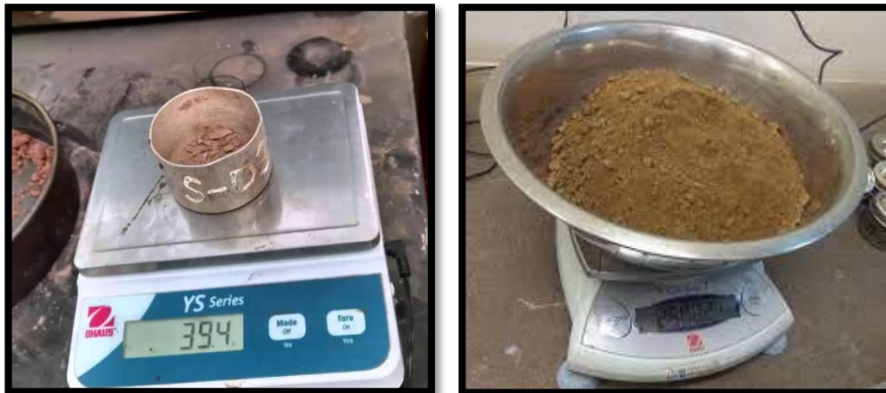
Fig. N° 11 – Determinar la masa del recipiente más masa de la muestra húmeda
