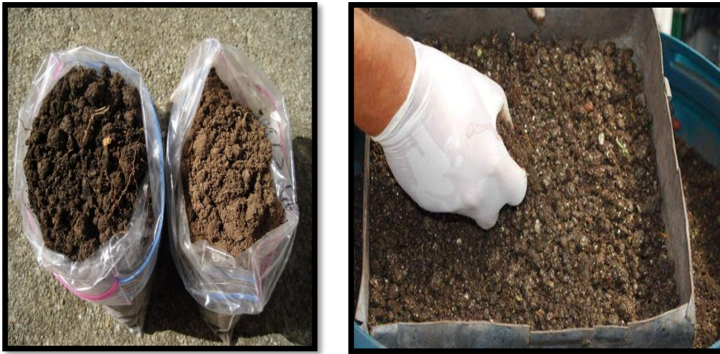
Fig. N° 16 – Muestra húmeda para realizar el ensayo de Gs
