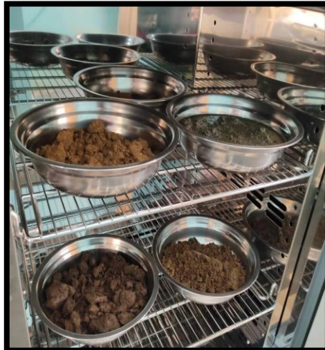
Fig. N° 15 – Secado de la muestra de suelo en el horno
